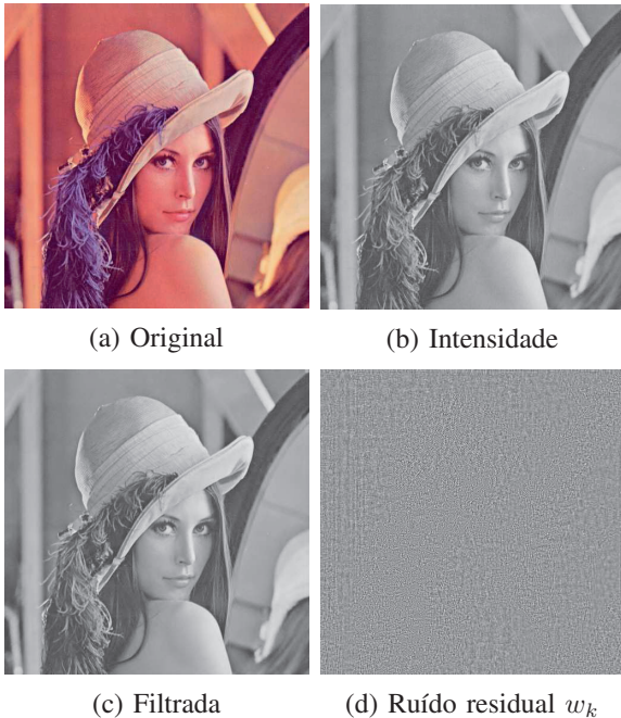
Figura 2. Pré-processamento em imagem para obter o ruído residual utilizando a Equação (1).
